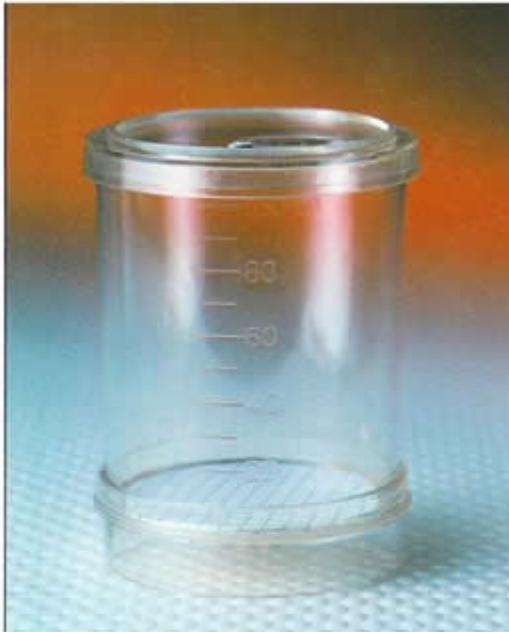
El Monitor Linsan es un dispositivo desechable de filtración diseñado para la recuperación de microorganismos de aguas, bebidas y vinos . Se pueden filtrar volúmenes de hasta 100 ml., y convertir la unidad desensamblada en una placa de cultivo para su posterior incubación .
